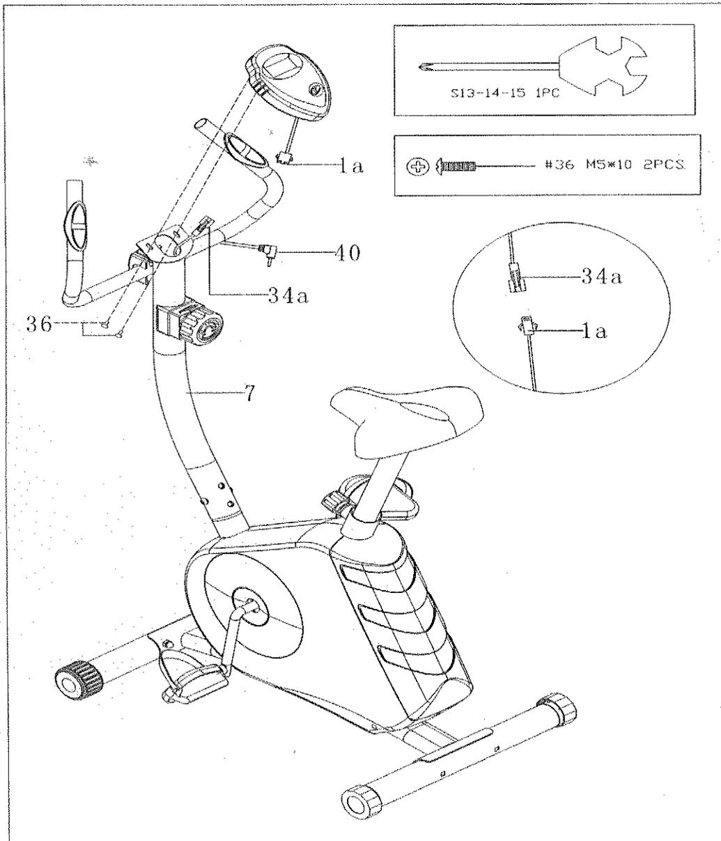
Conecte el cable de la consola (1a) con el de la bobina (34a); aparece el equipo bloqueado (1) en el tablero de la computadora del tubo unido(7) con el perno (36), inserte el cable (40) en la bodega de la espalda de la computadora, y se completa la instalación.
